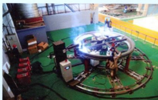
焊机器人现场焊接核电汽轮机环式隔板产品
