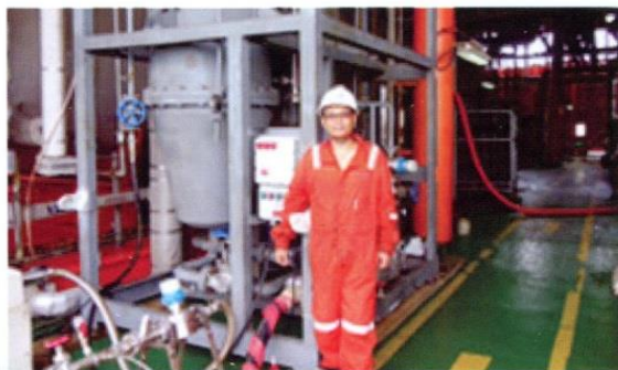
旋流气浮一体化设备在 JZ25-1 中心平台试验
