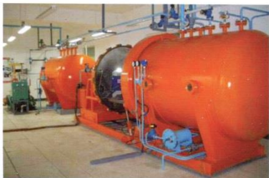
国内最大的水下干式高压焊接工艺试验系统
