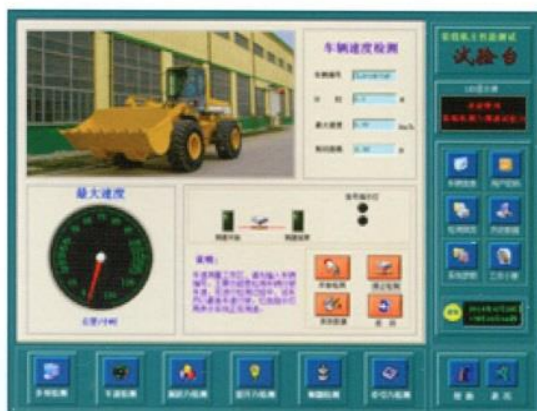
装载机力性能试验台测试系统人机交互界面
